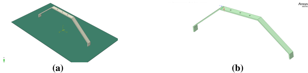
Gambar 2 (a) Pemodelan Leaf Spring Pada Software Abaqus CAE (b) Pemodelan Leaf Spring pada Software Ansys Workbench
